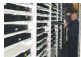
Étagères à plateaux coulissants SMD Easy Loader. Ces étagères uniques dans leur catégorie sont équipées à l'avant de roulements permettant un glissement fluide qui aide à charger et à décharger les boîtes de stockage les plus lourdes.
