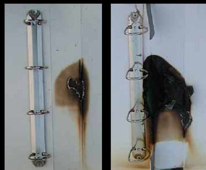
Test de résistance au feu de boîte classeur en carton plein Premier Duo (gauche) VS boîte classeur en carton ondulé (droite).
