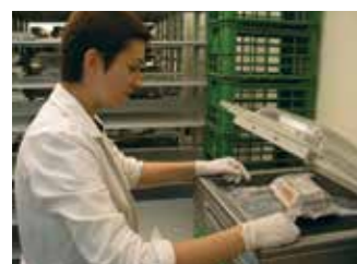
Utilisation d'ArchiPress™ pour le séchage à l'étouffé des matériaux endommagés
