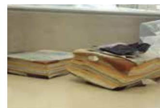
Test sur volumes identiques – Prague. Le livre à gauche est séché avec la méthode étouffée. Le résultat est plus satisfaisant que celui séché au froid sur l'image à droite.
